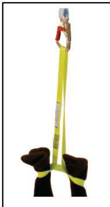
Fig. 1. cinghia di salvataggio di classe C. è progettato in modo che la persona da salvata è mantenuto in una testa in giù con le cinghie intorno alle caviglie durante l'azione di soccorso se possibile, le braccia e la testa devono essere protetti. PRODUTTORE euroline® marchio A-HABERKORN & CO. GMBH; Freistadt http://www.a-haberkorn.at/
